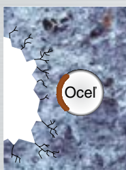
Odstráňte popraskaný betón z konštrukcie
